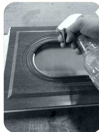
Bagnare la superficie con l'ausilio di uno spruzzino
