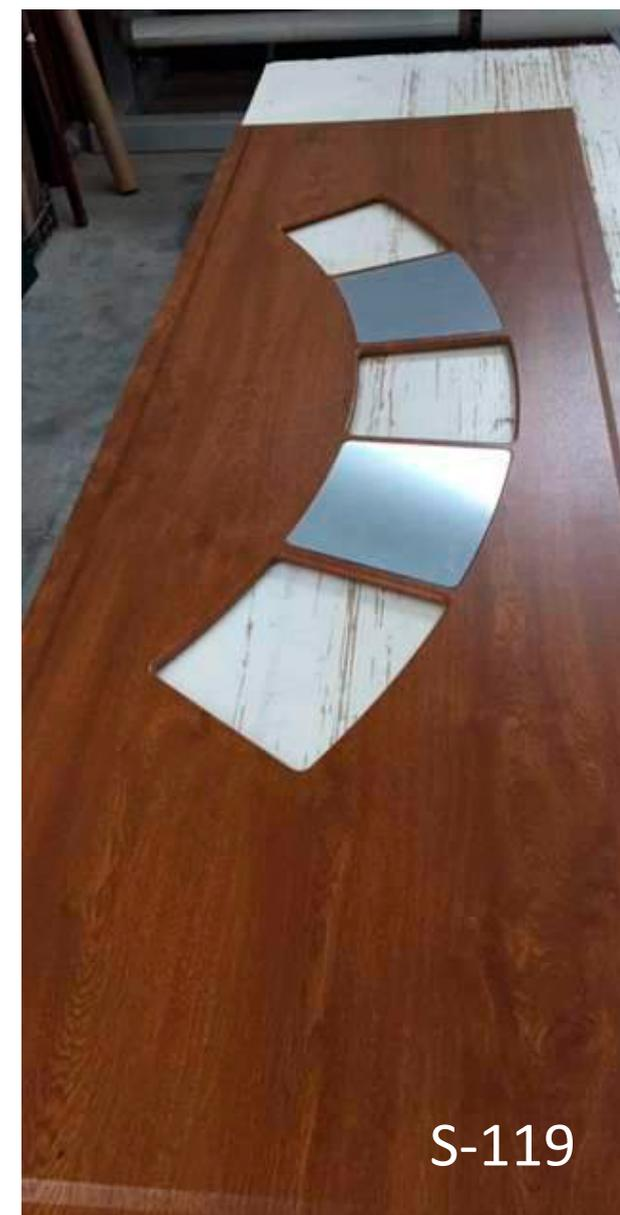
**Sistema di inserimento di un'unica lastra di vetro rettangolare, con la chiusura a clip, senza cornici fermavetro riportate che prende forma con la sovrapposizione del pannello.**
